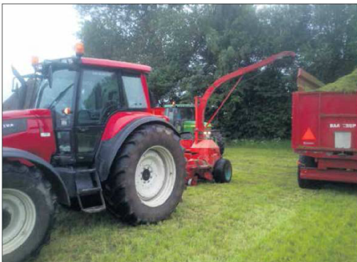
Hos Søfælde I/S snitter de selv græsset med en ældre bugseret Kverneland Ten X. (Foto: Kim Søgaard Rasmussen)
